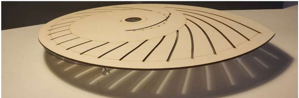
Fig.44/ Prototipo 2.2_legno. Script per la simulazione del cinematismo per il progetto della base. La registrazione del movimento consente di disegnare i binari per costruire il meccanismo.
