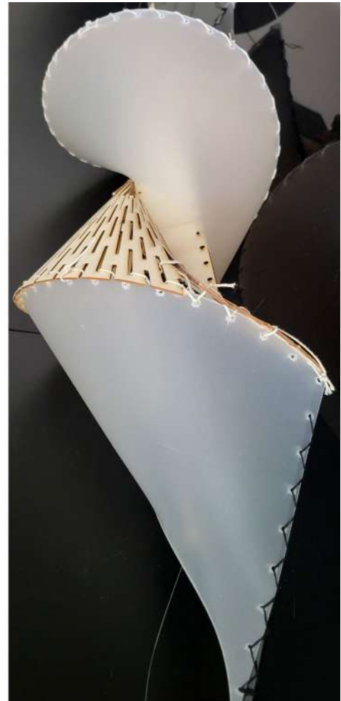
Fig.34/ Elicoide sviluppabile. Prototipo 1.3_ polipropilene e multistrato. Dettagli del sistema di vincoli. Le diverse caratteristiche dei due materiali generano tensioni che determinano alcune rotture della falda di multistrato.
