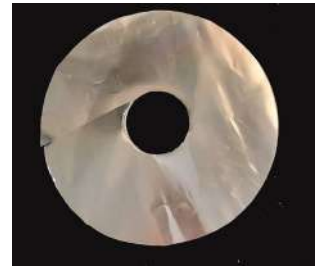
Fig.35/ Elicoide sviluppabile. Prototipo 1.4_alluminio. Il prototipo in alluminio composto da una sola falda si modella facilmente grazie alla duttilità del materiale. Una volta definita la forma non sono necessari vincoli per bloccarla.
