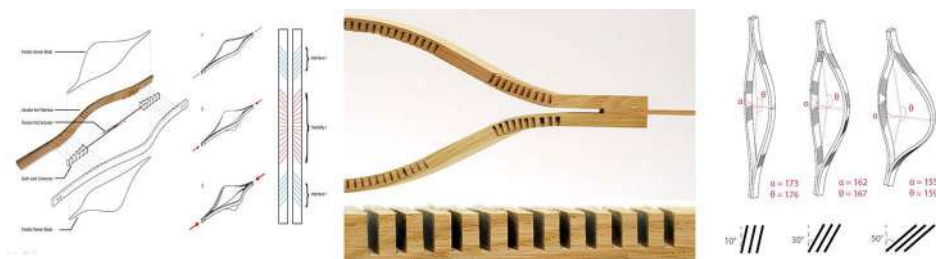
Fig. 5/ Tagli su un solo lato del pannello. Distribuzione dei tagli in funzione della configurazione di progetto. Menges 2011.
