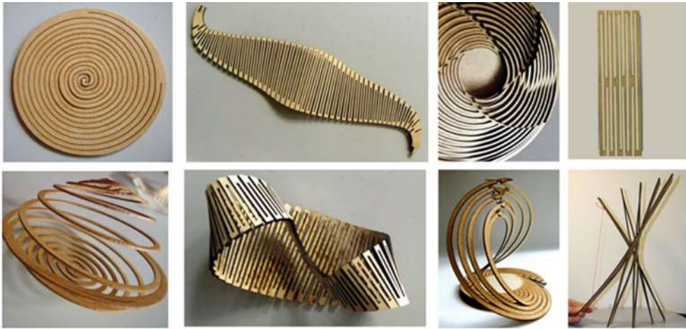
Fig. 9/ Tagli passanti diverse tipologie: taglio a spirale, taglio a zig-zag, taglio a frange e taglio a fessura.
