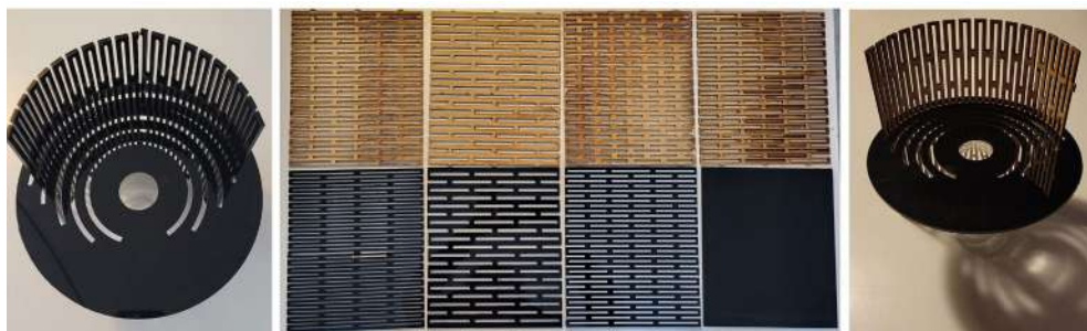
Fig. 15/ Alcuni dei campioni realizzati per definire la distribuzione del pattern in funzione della curvatura. Materiali utilizzati: MFD 3 mm e plexiglass 3 mm
