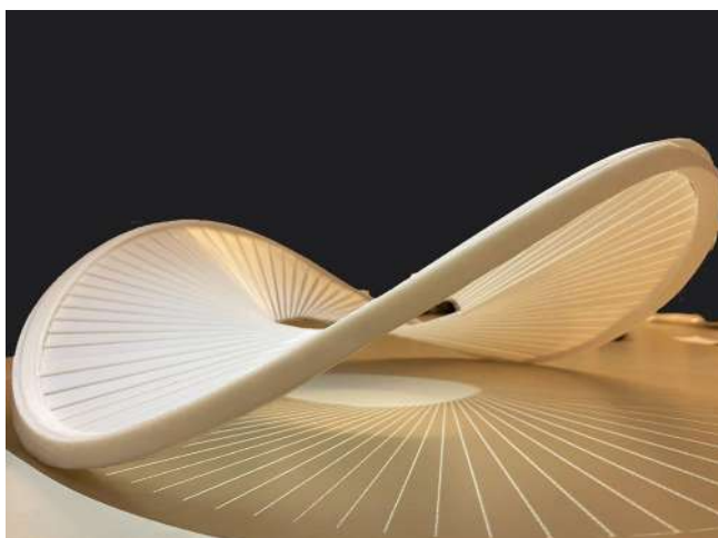
Fig. 57/ Prototipo 3_PLA Pezzo realizzato sperimentando la tecnica di stampa su tessuto. Processo di stampa 3d.
