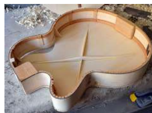
Fig. 2/ Kerfing tradizionale: in un pannello di un determinato spessore la curvatura dipende dalla larghezza, dalla profondità e dalla distanza dei tagli.
