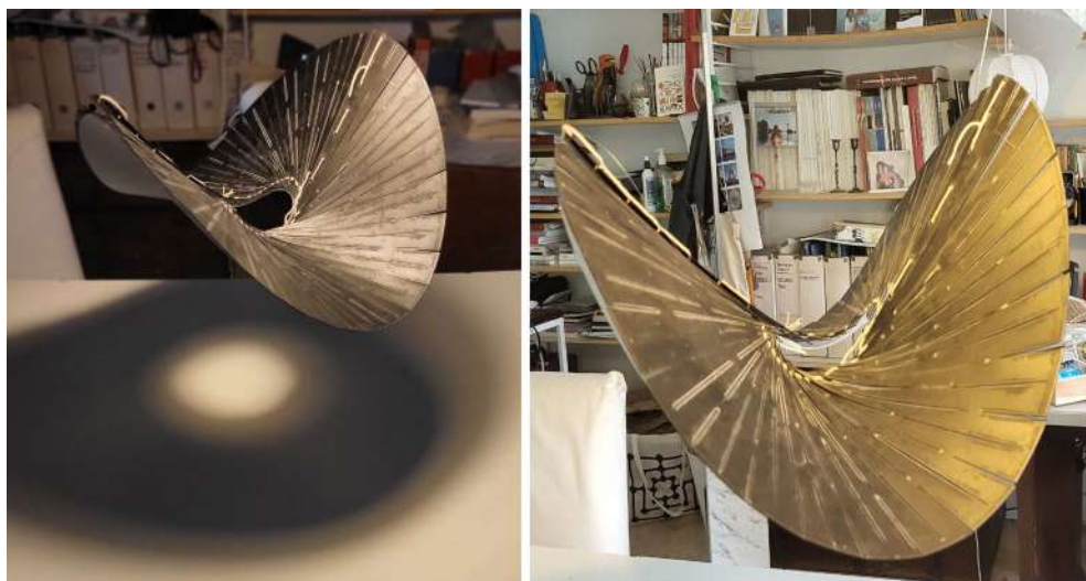
Fig.53/ Prototipo 2_polipropilene. Tangenziale intersezione. Applicando un pattern di taglio al polipropilene le tensioni si annullano.
