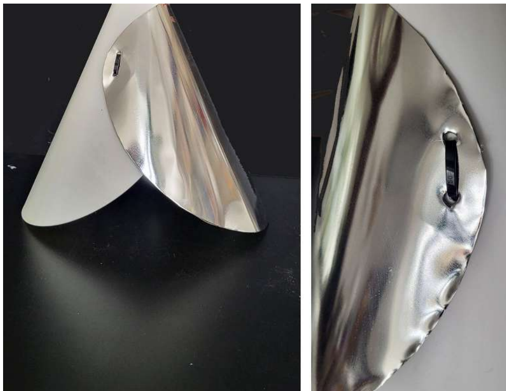
Fig.16/ Yin_Yang. Versione del prototipo in polipropilene e alluminio. In questo caso la sperimentazione consiste nell'utilizzo di materiali con diverse caratteristiche: un materiale duttile ed un materiale elastico. Due fori passanti consentono di collegare i due pezzi.
