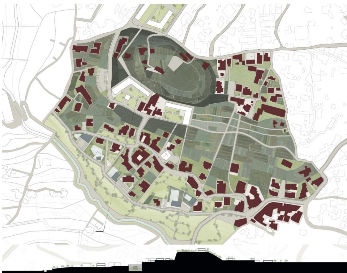
Figura 1 | Particolare del progetto di riconfigurazione per la frazione Maio (gruppo 'Kintsugi'). In rosso gli edifici storici, in bianco le corti residenziali di nuova sostituzione, in azzurro gli edifici per servizi e le attrezzature. Fonte: immagine originale.
