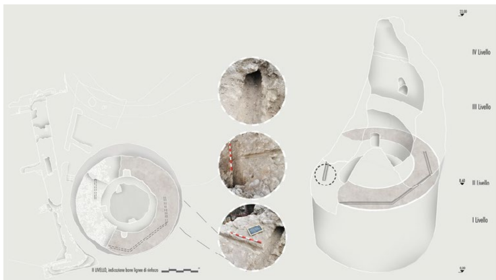
4: Cerreto antica (Cerreto Sannita, Benevento). Schema con indicazione della posizione dei rinforzi lignei disposti longitudinalmente alla muratura (Giacco, Iovine 2021).
