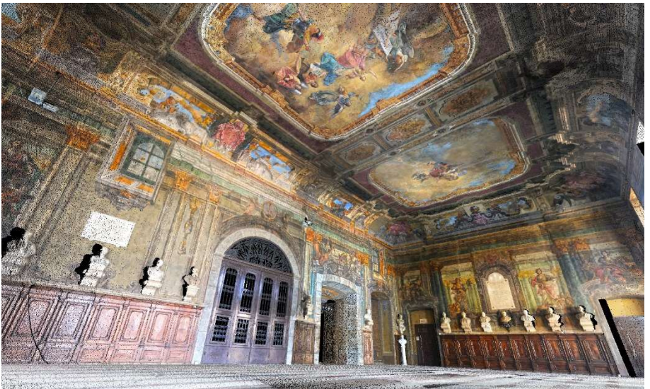
Figura 4: Rilievo laser scanner del Salone dei Busti.
