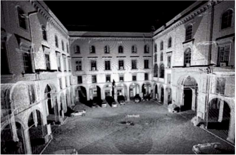
Figura 3: Rilievo laser scanner del cortile di Castel Capuano.
