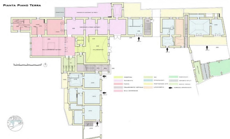
Figura 13 - Progetto: distribuzione funzionale del piano terra
