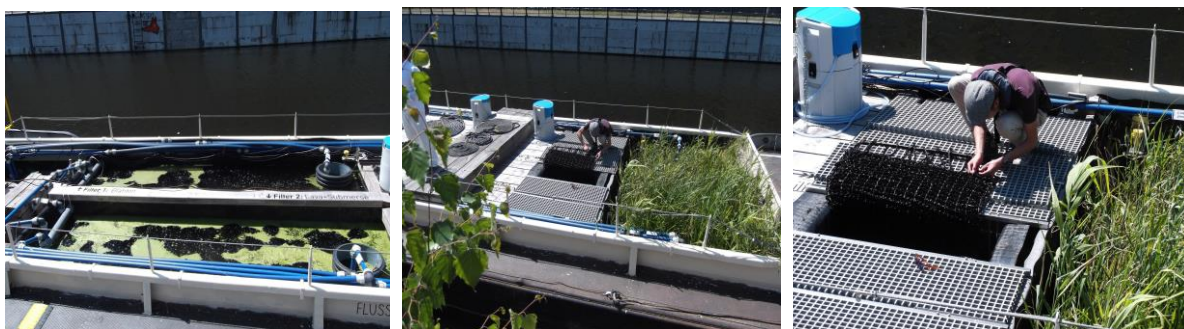
Fig. 45_ il prototipo di filtro a bordo dell’imbarcazione Hans-Wilhelm . (a) i filtri 1 e 2 a base argillosa, (b) il filtro 3 a base di piante acquatiche, (c) il filtro 4” reagente” a base di molluschi d’acqua dolce, (foto: Dell’Acqua, 2018)
