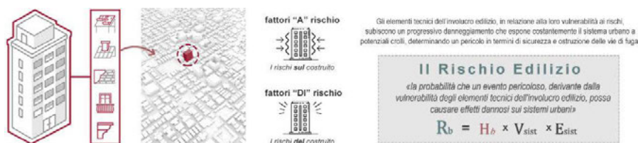
Figura 2 - (sinistra) Gli elementi tecnici dell’involucro come fattori “A” rischio rispetto ai rischi esterni e come fattori “DI” rischio per i sistemi urbani. (destra) Definizione del Rischio Edilizio connesso alla vulnerabilità degli elementi tecnici dell’involucro - © Immagine adattata a partire da Castelluccio et al., 2023.
