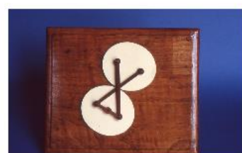
Ellissi che rotolano l'una sull'altra progettato a Napoli dal professore Marcolongo: è ispirato ad uno dei modelli editi dalla ditta Brill- Schilling
