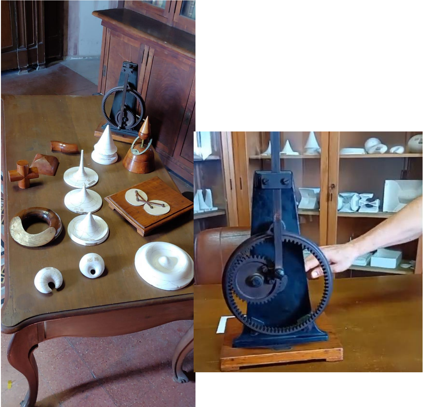
Figura 19. Coppia di Nasir al-Din al-Tusi (XIII sec) che mostra come con composizione di due moti circolari si possa ottenere un moto rettilineo 1
